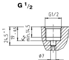
Тип 89X.23.510 ввинчивается в гнездо, изготовленное по ДИН 16288 или, если разделитель должно быть в виде уплотнительного кольца, то в специальное гнездо с резьбой G1/2 (спецификация см. чертеж)
