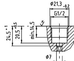
**Присоединение к измеряемому давлению с разделителем и уплотняющим кольцом Модели F-11/Модели IF-11**
