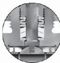
Сальниковые уплотнения штока динамического нагружения
